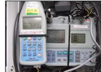
騒音・振動の常時監視は騒音計及び振動計により測定します。
