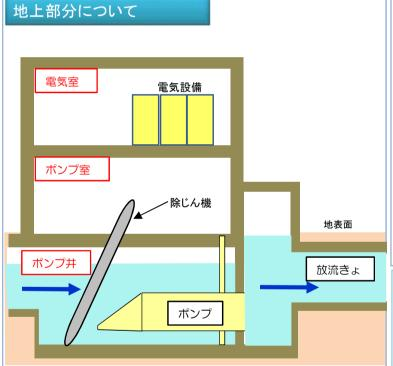
ポンプ井には、ポンプにゴミが混入しないようにゴミをかき上げる設備(除じん機)を設置しています。ポンプ棟(2階)には、ポンプを操作するための電気設備を設置するためのスペースを設けています。
