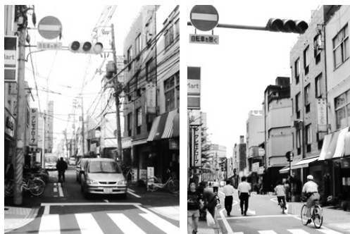
電線の地中化前と地中化後の比較
