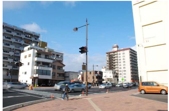
電線類の地中化や街路灯・信号機・標識類等の統合がすっきりした歩道空間を形成している
