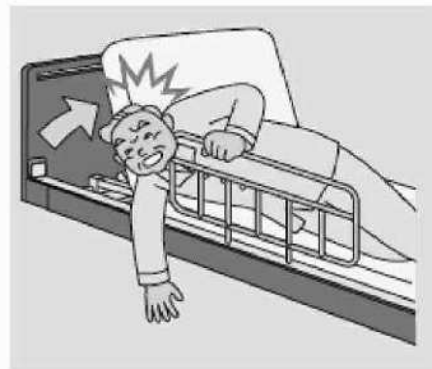
手すり等とマットレスに挟まれる事故
