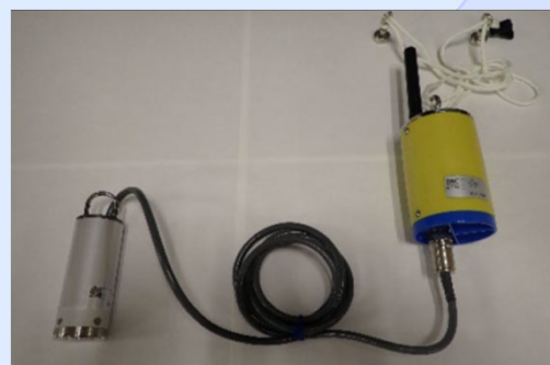
漏水音センサ設置状況
