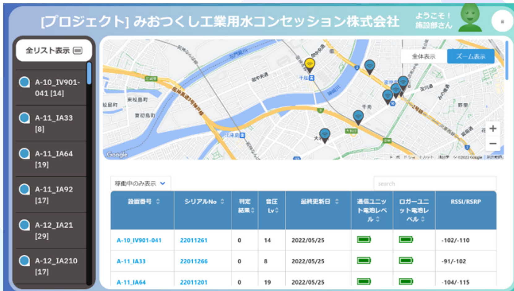
漏水センサのクラウド監視画面
