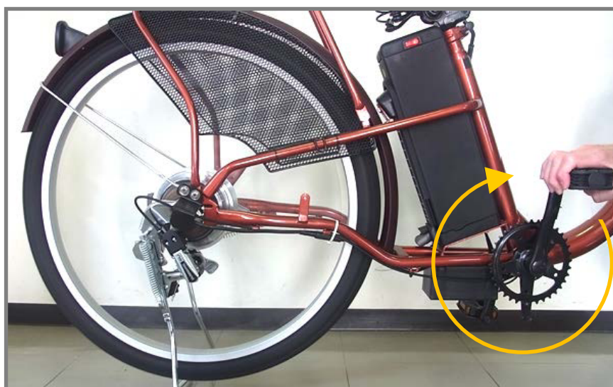
写真3. ペダル回転によるモーター駆動
