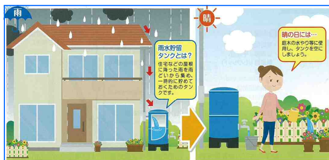
図5-7 戸別雨水貯留タンク
