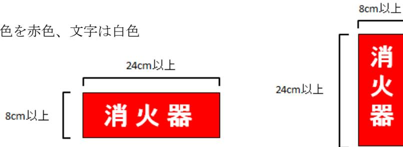
2 大型消火器の設置場所に設ける標識の形状等は、次によるものとする。◆
