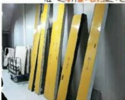
簡易式止水板：コンパネを貼りあわせて中空の函体をつくっている土のうを併用して設置する。浸水深30cmまで対応可能
