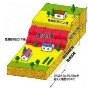
急傾斜地の崩壊
