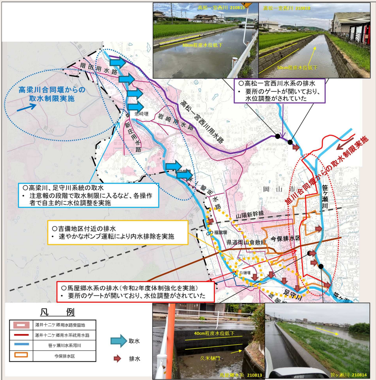
笹ヶ瀬川西側地区における事前の水位調整成果事例
