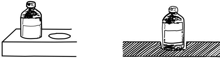
図2-2 くぼみによる容器の滑り止めの例
