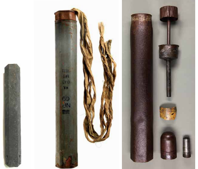
左から 40 M50 焼夷弾 (AN-M50A2、弾体のみ) 41 M69 焼夷弾 43 ~ 47 M74 焼夷弾の弾筒と部品 40・41 は山本達也所蔵・画像データ提供
