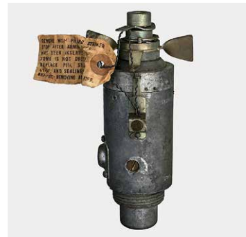
42 M145 信管 山本達也所蔵・画像データ提供 集束焼夷弾 M18 などの弾頭につけられます。羽の回転数によって安全を解除し、目的の高度で爆発します。
