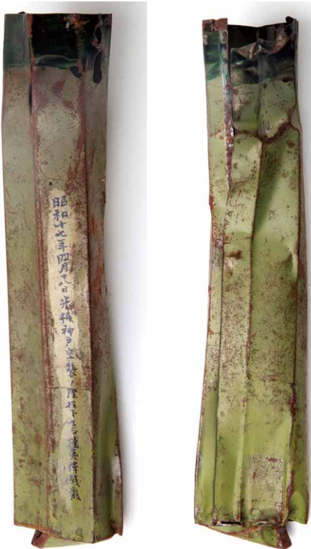
32 M 54 焼夷弾 山本達也所蔵・画像データ提供 M 54 焼夷弾にはテルミットという燃焼材が詰められており、高温で約1分燃焼するものでした。「昭和十七年四月十八日米機神戸空襲ノ際降下セシ焼夷弾残骸」と記入されており、神戸に投下されたものと思われます。
