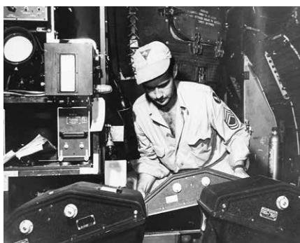
カメラ (K-18) からフィルムパックを取り外すところ。フィルムサイズは 450 × 230mm*
