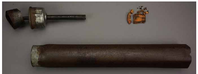
255 処理後のM74焼夷弾 錆を落とし、樹脂を含浸させた状態です。
