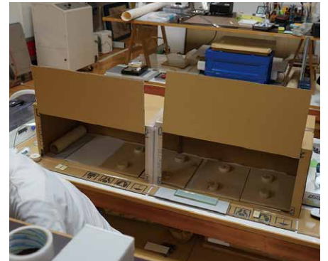
③印画面のゼラチン質を傷つけないよう、養生して加重し、平坦に伸ばしていきます。
