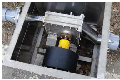
低い同期速度で回すと商用電源と同じ単相100Vの電気が直接取り出せる特長を持つ。
