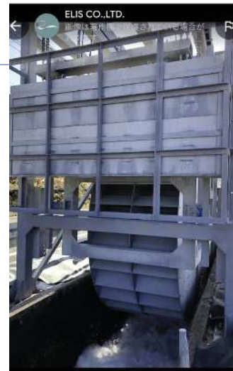
効率の良い水車は、水の飛散が少ないのが特徴。
