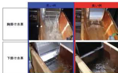
効率の良い水車は、水の飛散が少ないのが特徴。
