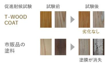
T-WOOD COAT 促進耐候試験 試験前 試験後 劣化なし 塗膜が消失
