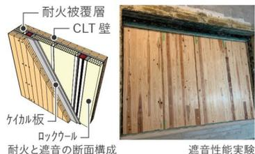
T-WOOD TAIKA CLT 耐火と遮音の断面構成 遮音性能実験
