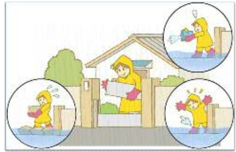
図5-12 止水板設置イメージ
