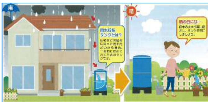
図5-7 戸別雨水貯留タンク
