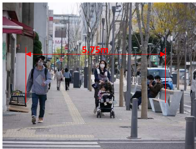
▲拡幅された歩道（最大5.75m）
