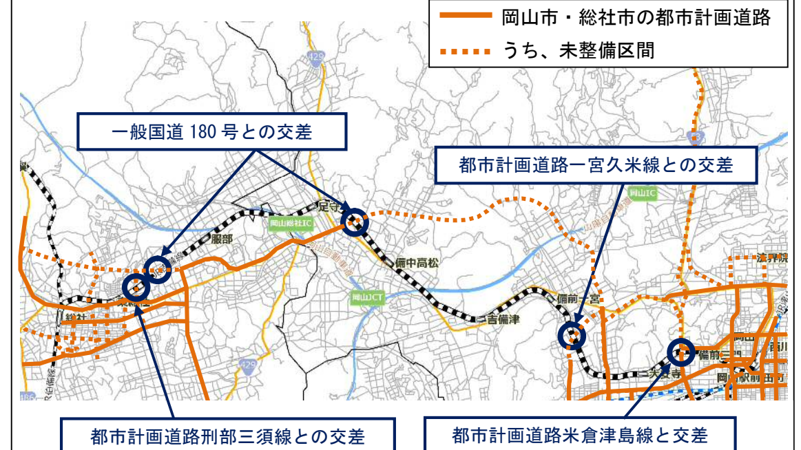
図 主要道路との交差箇所
