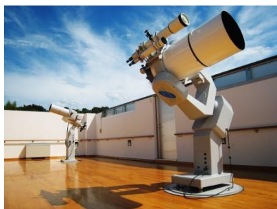
【右から40cmシュミットカセグレン式反射望遠鏡と 20cmクーデ式屈折望遠鏡】
