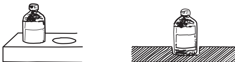
図2-2 くぼみによる容器の滑り止めの例
