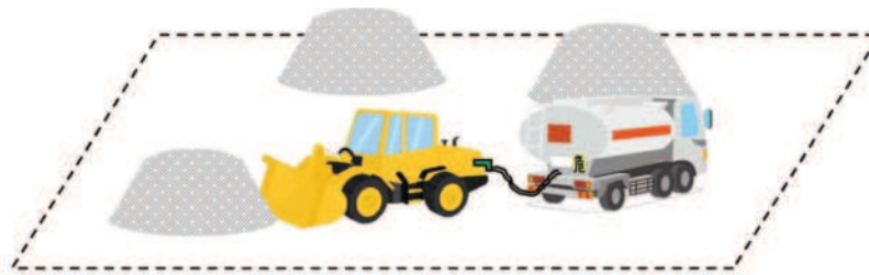
【第1-19図 建設現場等で土木建設重機等に給油する場合】
