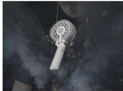
【リチウムイオン電池の破裂(提供元:NITE)】
